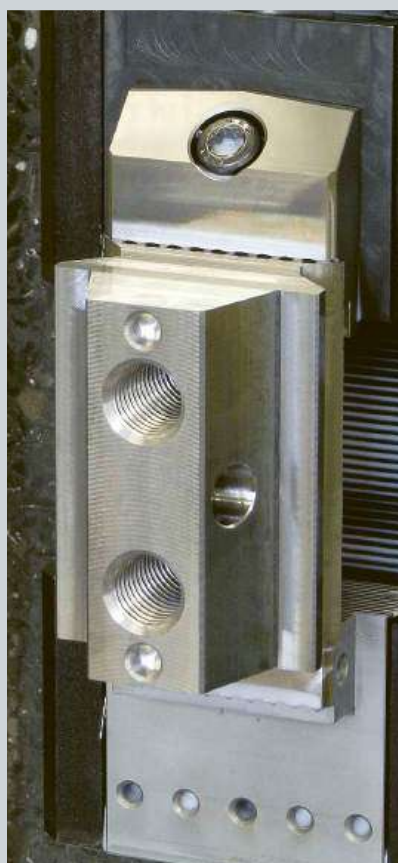
Lineare Direktprägespannung Linear direct stamping module
