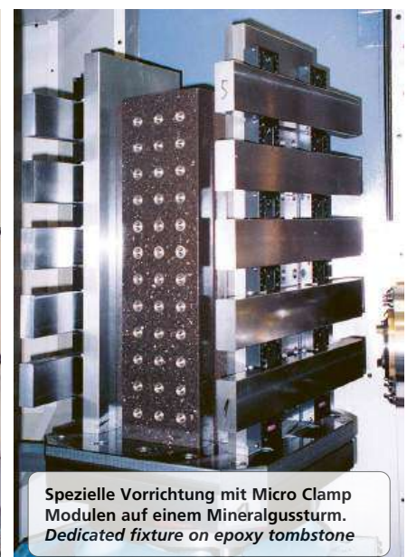
Chaotische Fertigung auf einem Mineralgussturm in Kreuzform. Mixed set up on cross epoxy tombstone.
