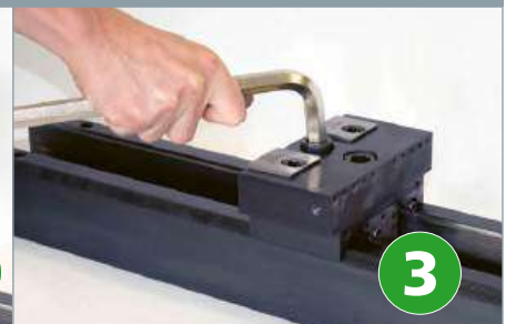
Zwei Schrauben anziehen Fasten two screws
