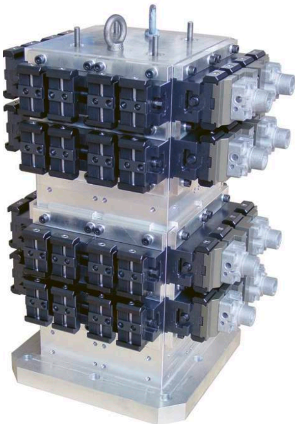
32 Zentrischspanner auf einem Spezialturm Centric vices installed on a special tombstone
