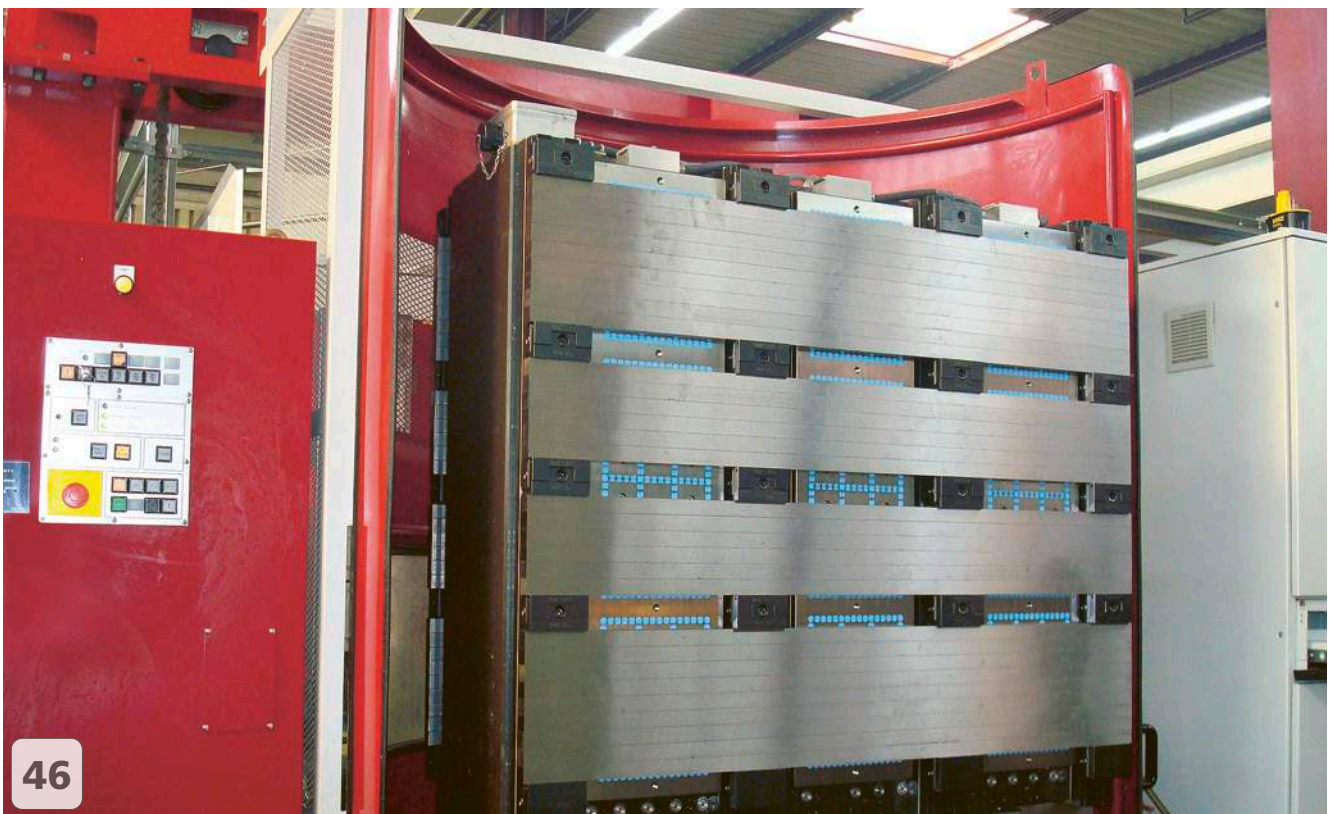
45 Stahlmineralguss-Säulen mit Power Clamp für die Fertigung von Flügelteilen. Steel epoxy frames machining wing parts on a Makino machine
